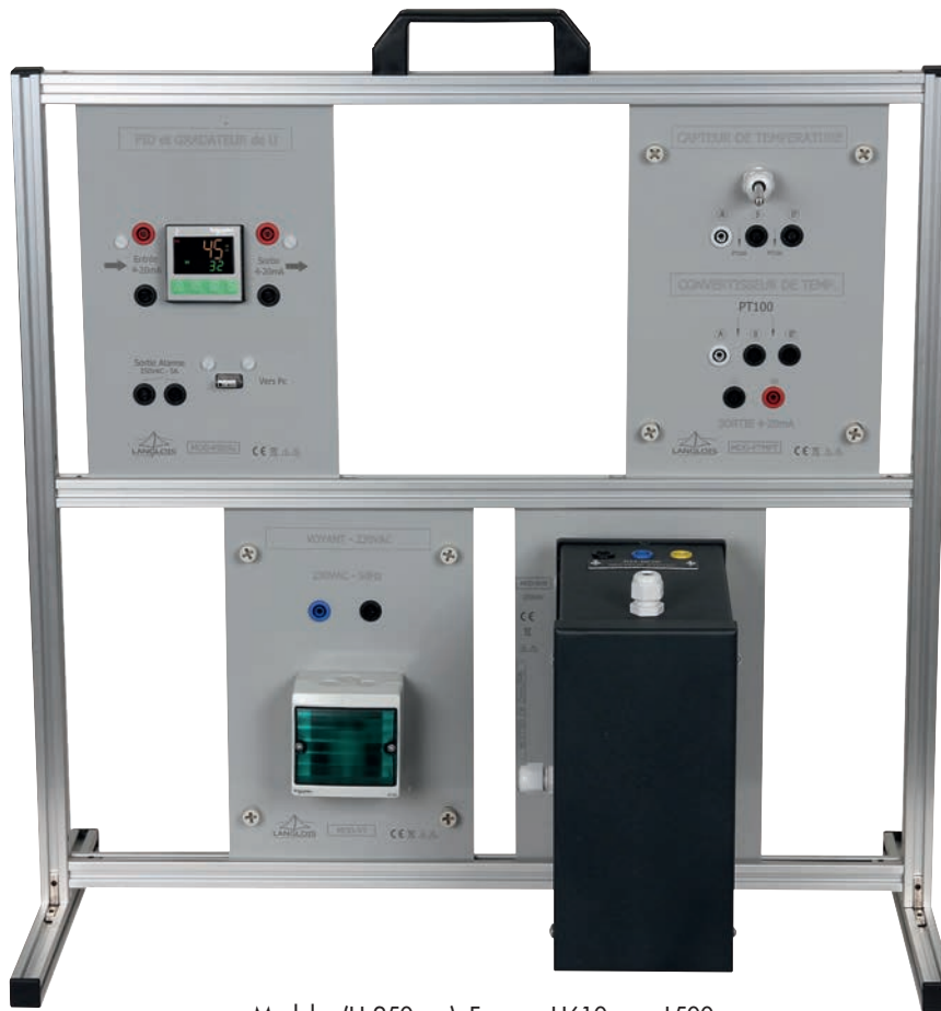
Modules (H-250mm). Frame : H610mm - L500mm.
